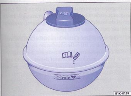
Afb. 15 In de motorruimte: Koelvloeistofexpansiereservoir
